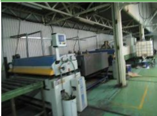
Линия цифровой печати высокоглянцевой или матовой поверхности для панелей МДФ
