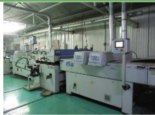
Линия цифровой печати высокоглянцевой или матовой поверхности для панелей МДФ
