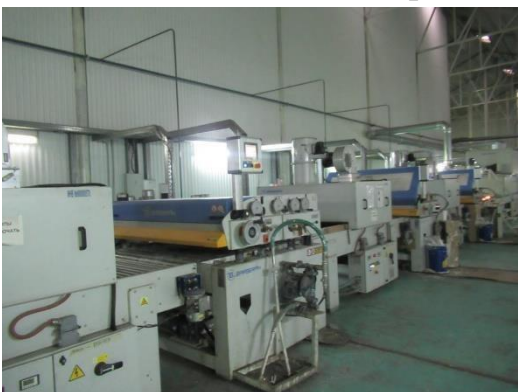
Линия цифровой печати высокоглянцевой или матовой поверхности для панелей МДФ
