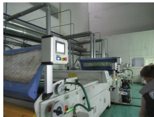
Линия цифровой печати высокоглянцевой или матовой поверхности для панелей МДФ
